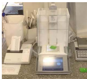
Figure 4: Balance analytique XP 105 avec son imprimante annexe
