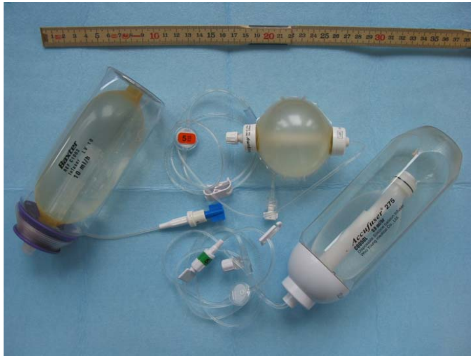
Figure 1 : Perfuseurs mécaniques élastomériques (De gauche à droite : Infusor de Baxter, Easypump de B/Braun et Accufuser de Theramed)
